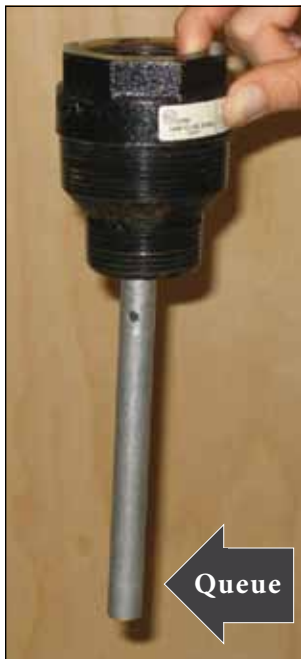
4.9a Sifflet d'avertissement pour réservoir d'huile de chauffage : la queue du sifflet d'avertissement fait saillie dans le réservoir d'huile; le tuyau de ventilation est vissé dans la partie supérieure du sifflet d'avertissement.
